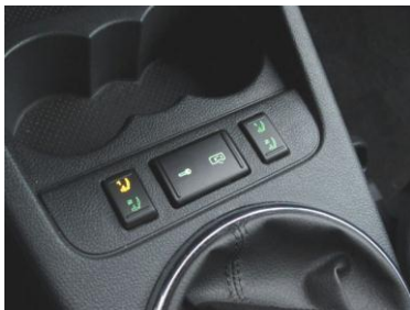
Obr. 1 Umístění přepínačů na středovém tunelu Fabie II, Roomsteru
