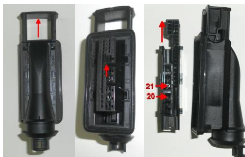
Obr.4 Demontáž konektoru – sloupek B
