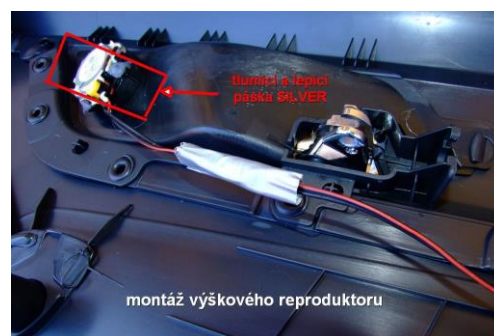
Obr. 4 Umístění výškového repro
