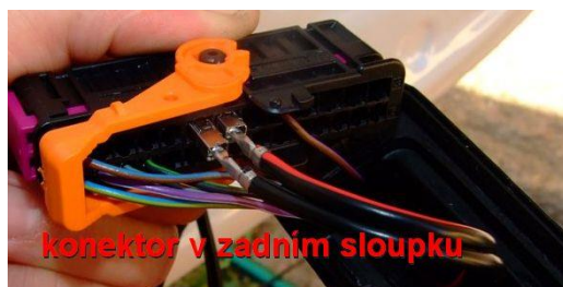
Obr.5 Osazení vodičů do konektoru ve sloupku B
